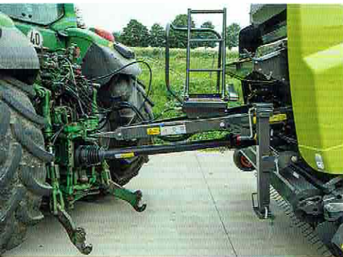
Die lange Deichsel ermöglicht weite Lenkeinschläge. Leider ist sie nicht ausreichend verstellbar.
