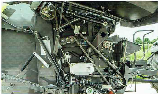
Auf der rechten Seite befinden sich die Kettentriebe und der Ölvorfat.
