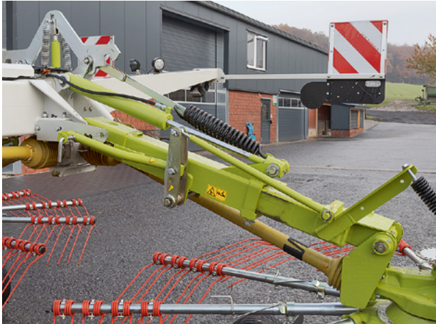
Ein Teleskoprohr trägt den Kreisel, eine Schraubenfeder entlastet ihn. Zur Veränderung der Schwadbreite wird der Bolzen in einem Lochraster umgesteckt.
