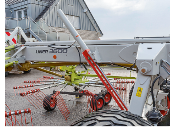
Der Hydraulikzylinder hebt und senkt den Rahmen für den Straßentransport.
