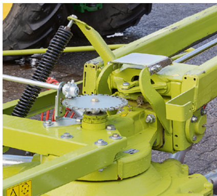
Die Aufhängung erlaubt Bodenadjustierungen längs und quer zur Fahrtrichtung.
