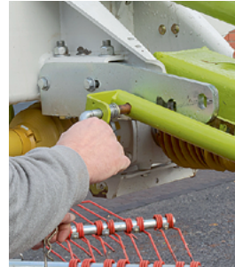
Ein Teleskoprohr trägt den Kreisel, eine Schraubenfeder entlastet ihn. Zur Veränderung der Schwadbreite wird der Bolzen in einem Lochraster umgesteckt.
