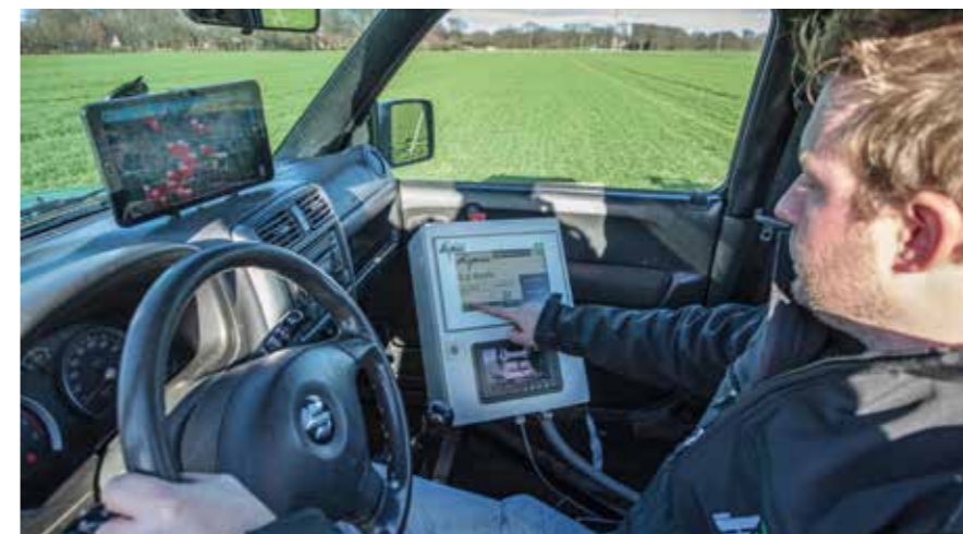
Neben dem Fahrersitz befindet sich u.a. ein Computer für die Gerätesteuerung, ein Bildschirm zur Überwachung der Mischprobenbehälter und ein Etikettendrucker.
