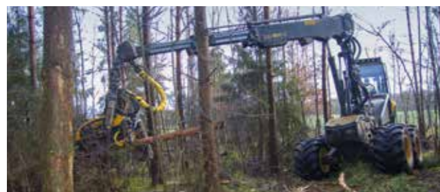
Der Harvester fixiert die Bäume, fällt sie und kann die Stämme entasten und für den Abtransport ablegen.
