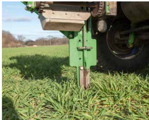
Während sich der Stecharm bei laufender Fahrt nach hinten bewegt, schert er mit einer Nut ein Bodenteilprobe ab.
