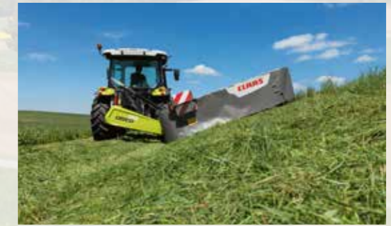
Die Seitenaufhängung erlaubt große Böschungswinkel am Hang auf- und abwärts.
