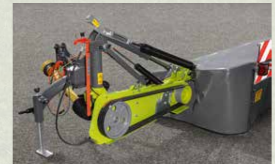
Der robuste Riemenantrieb dämpft Lastspitzen.
