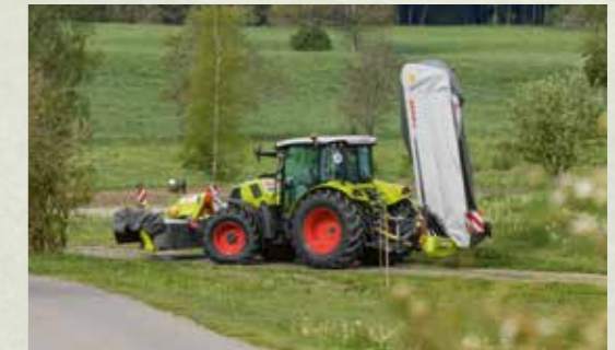
Durch die optimierte Transportposition klappt die Mäheinheit kompakt hinter den Traktor.
