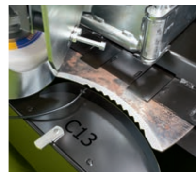
Für gute Futterqualität müssen die Messer von Ladewagen und Pressen richtig und vor allem regelmäßig geschliffen werden.
