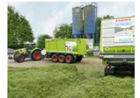
Mit der elektronischen Zwangslenkung erweisen sich die Wagen als sehr wendig.
