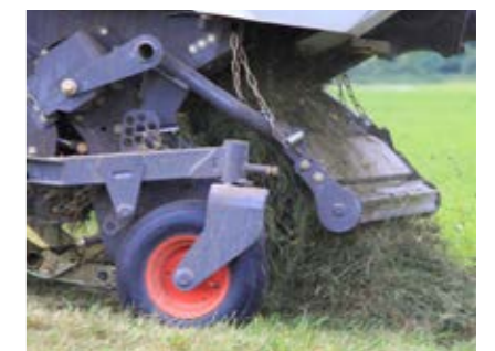
Die hydraulisch angetriebene Pickup perfektioniert den Gutfluss.
