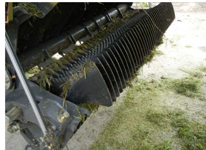
Dank beidseitiger Schneiden können die 40 Doppelmesser einmal umgedreht werden. So reicht ein Messersatz in Bichl über das ganze Jahr.
