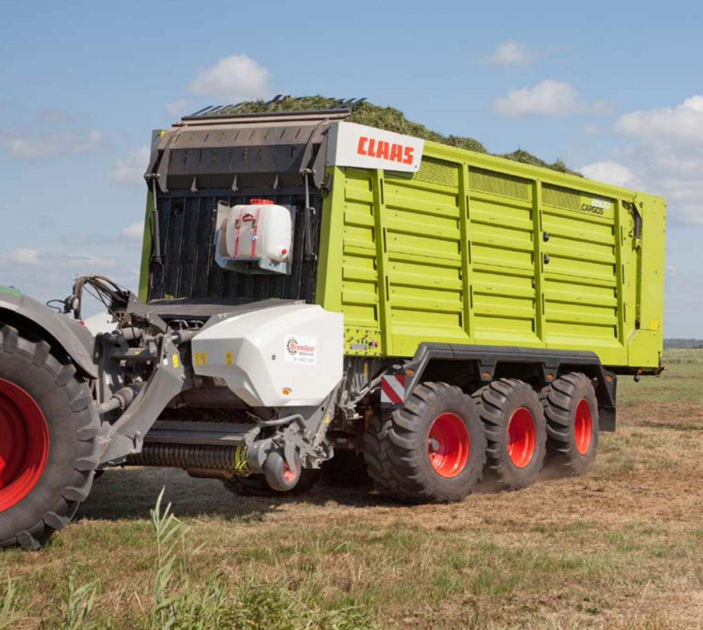
Dank Zwangslenkung erweist sich der CARGOS 8500 trotz seiner Größe als sehr wendig.
