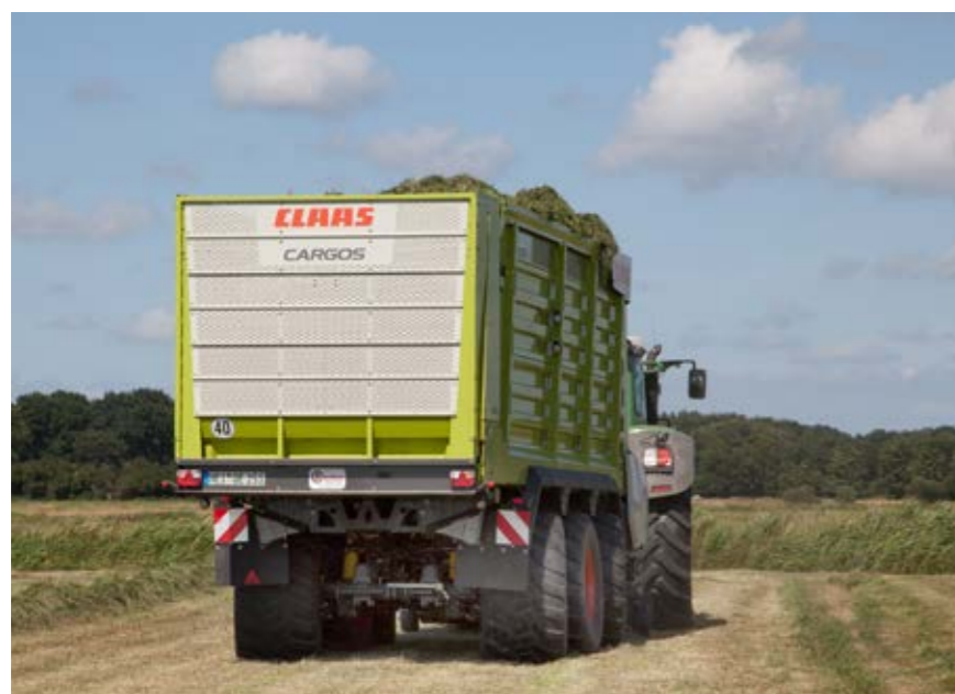
Dank Zwangslenkung erweist sich der CARGOS 8500 trotz seiner Größe als sehr wendig.
