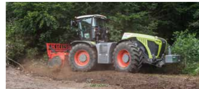
Der Forstmulcher arbeitet das geschredderte Material nur flach in den Boden ein.
