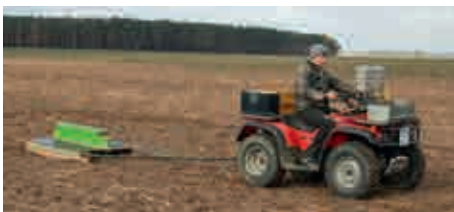
Elektrische Leitfähigkeit messen
