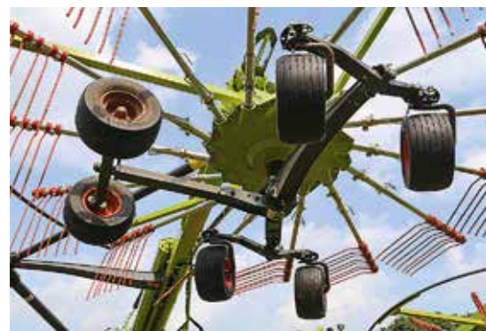
Das Sechsrاد-Fahrwerk mit großen Rädern ist optional erhältlich.
