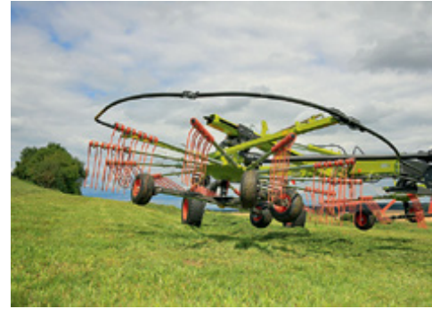
△ Der Schlauchgalgen, die Halterung für die Hydraulikstecker und die Abdeckung des Verteilergetriebes wurden neu gestaltet (Bild links). Der neue Halter für verbogene oder Ersatzzinkenträger ist so gestaltet, dass sich die Träger ohne Gummibänder befestigen lassen (Bild Mitte). Bei den Kreiseln ist ein Fahrwerk mit vier Rädern Standard, auf Wunsch sind auch sechs Räder möglich (Bild rechts).
