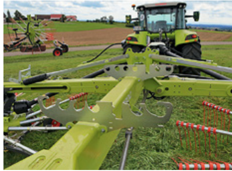
△ Der Schlauchgalgen, die Halterung für die Hydraulikstecker und die Abdeckung des Verteilergetriebes wurden neu gestaltet (Bild links). Der neue Halter für verbogene oder Ersatzzinkenträger ist so gestaltet, dass sich die Träger ohne Gummibänder befestigen lassen (Bild Mitte). Bei den Kreiseln ist ein Fahrwerk mit vier Rädern Standard, auf Wunsch sind auch sechs Räder möglich (Bild rechts).
