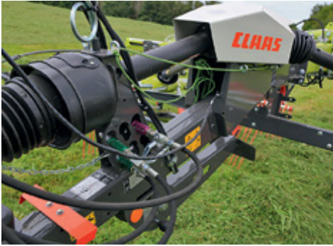
△ Der Schlauchgalgen, die Halterung für die Hydraulikstecker und die Abdeckung des Verteilergetriebes wurden neu gestaltet (Bild links). Der neue Halter für verbogene oder Ersatzzinkenträger ist so gestaltet, dass sich die Träger ohne Gummibänder befestigen lassen (Bild Mitte). Bei den Kreiseln ist ein Fahrwerk mit vier Rädern Standard, auf Wunsch sind auch sechs Räder möglich (Bild rechts).
