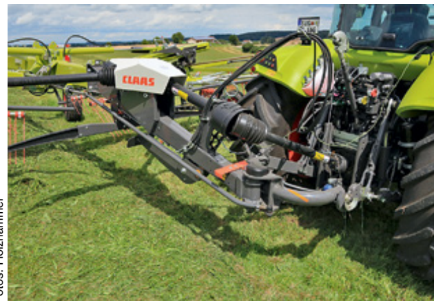
△ Der großzügige Lenkeinschlagswinkel von 80° erlaubt enge Wendemanöver (Bild links). Der Liner 2800 Trend legte das angewelkte Gras bei unserer Testfahrt in schöne, kastenförmige Schwade ab – sehr gut.
