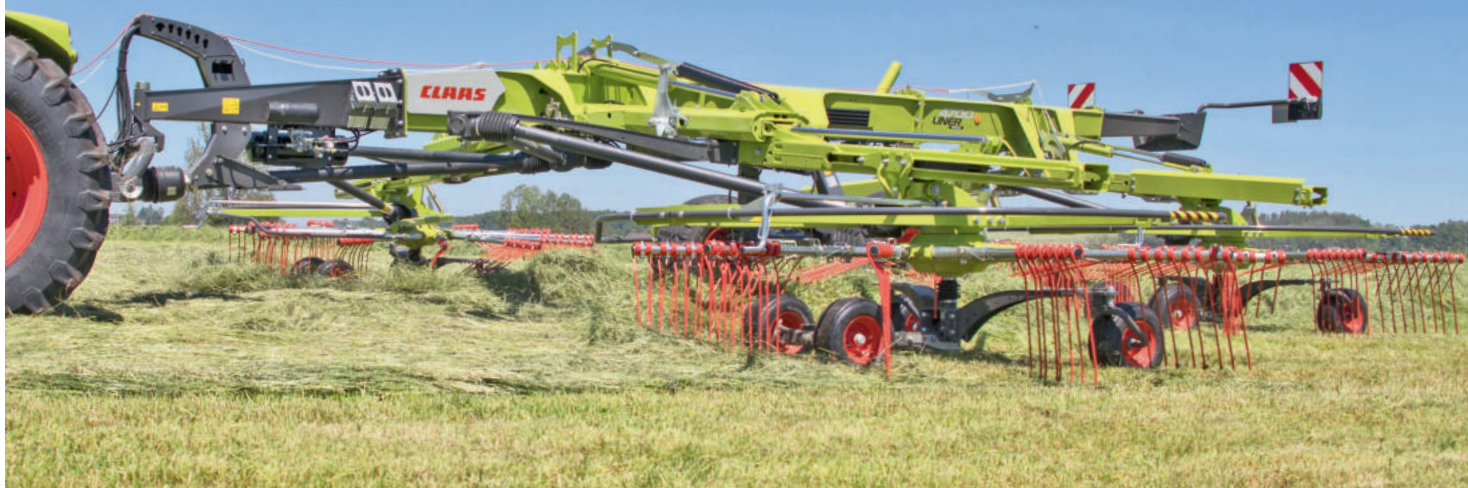
Aufgeräumt sieht der neue Vierkreiselschwader Liner 4700 aus. Rahmen, Fahrwerk, Antrieb und Seitenarme – fast alles konstruierten die Ingenieure neu.
