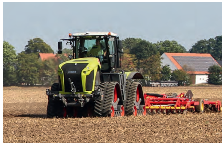
Seit Einführung der fünften Generation mit der Abgasstufe V (ab 2019) bietet CLAAS auch einen TRAC TS mit Raupenlaufwerken an.
