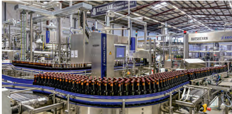
In der Abfüllanlage können bis zu 10.000 Flaschen pro Stunde abgefüllt werden.
