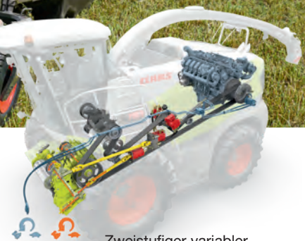
Zweistufiger variabler Vorsatzantrieb: hydraulisch vom JAGUAR für den Aufsammler und mechanisch für die Schnecke.
