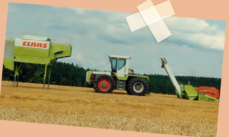
Prototyp Nr. 3 des Projekts 207 mit den Komponenten für den Mähdescheranbau.
