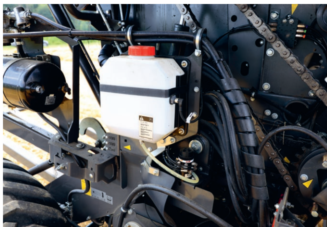
Automatische Kettenölung und gut gekennzeichnete Schmierstellen.
