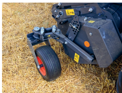
Die pendelnden Tasträder lassen sich für den Transport einklappen.
