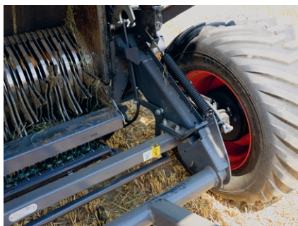
Der neue Fahrwerksrahmen ermöglicht größere Räder für mehr Bodenschonung.
