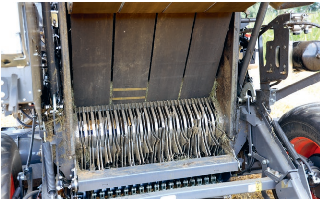
Der neue 17-Messer-Schneidrotor hat eine theoretische Schnittlänge von 60 mm.
