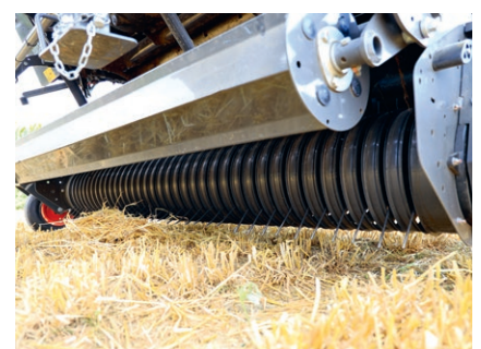
Die 2,35 m breite Pick-up (Option) hat vier gesteuerte Zinkenreihen.
