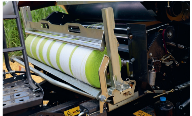
Die jetzt tiefer positionierte Netzbindung lässt sich leichter befüllen und war zuverlässig.
