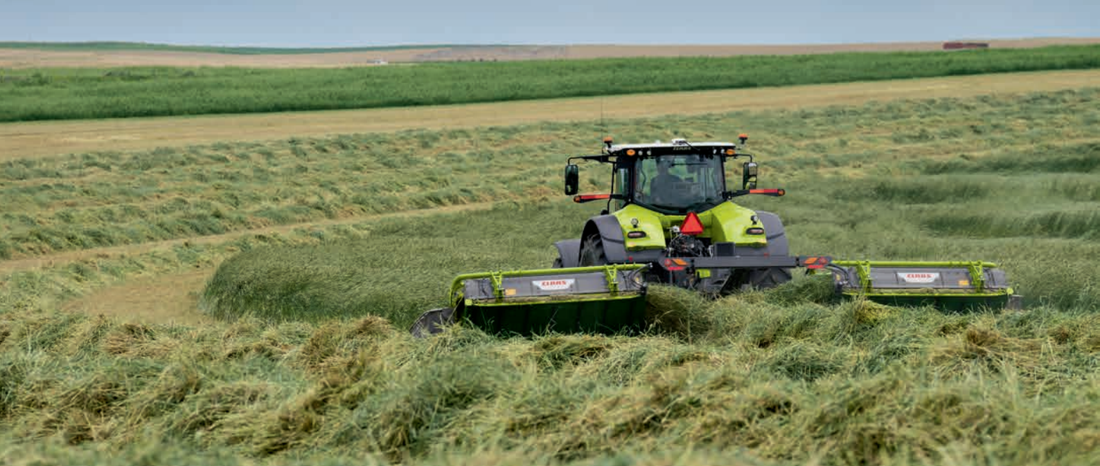
Die Dreifach-Mähkombinationen an Traktoren der 400-PS-Klasse schaffen auch solche großen Aufwüchse.
