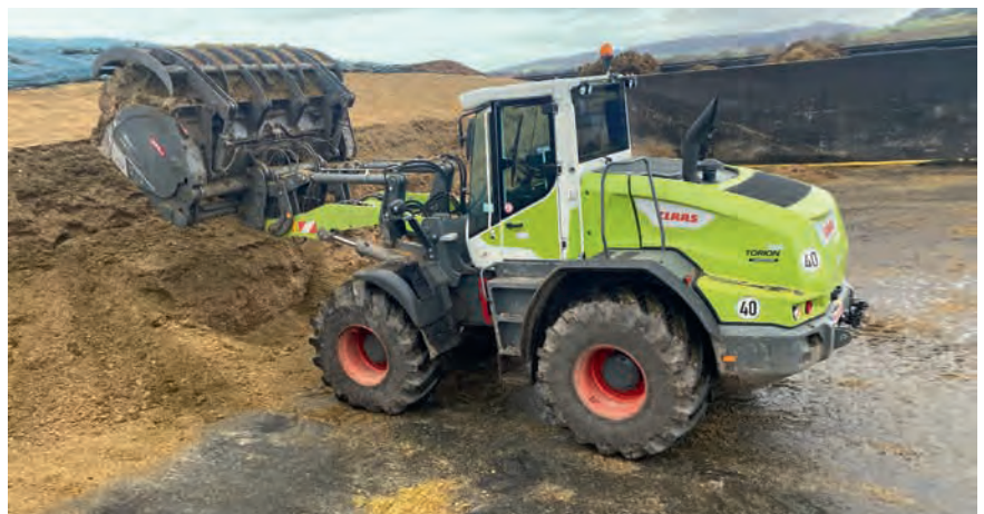
Die spezielle Greifschaufel mit Reißschiene hinterlässt am Silo eine saubere Anschnittfläche.
