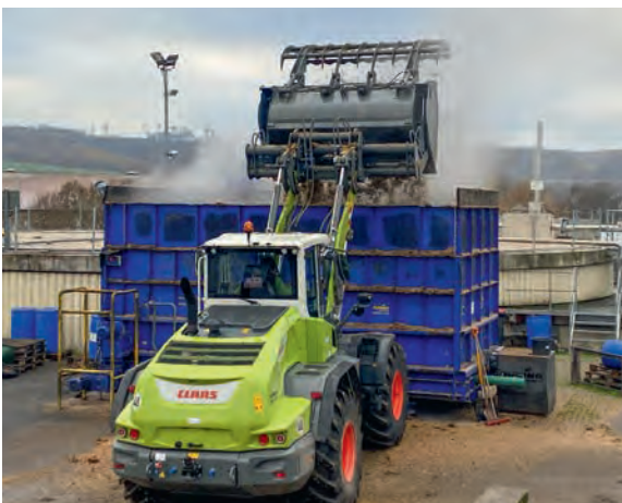
An der eigenen Biogasanlage bedient der TORION den Dosierer.
