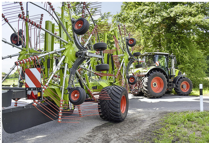
◁ Auch engere Feldeinfahrten waren mit dem Liner im Test kein Problem. Er bleibt mit 3,89 m Höhe eingeklappt recht deutlich unter der 4 m-Marke.
