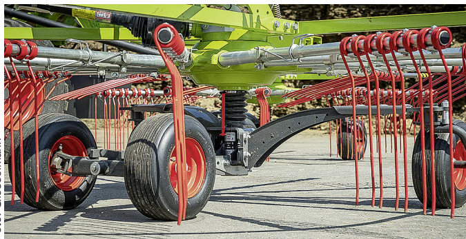
◁ Die Rechhöhe stellt man in der Pro-Variante hydraulisch ein. Ansonsten gibt es eine klassische Handkurbel mit einer Skala unter dem Kreisel.
